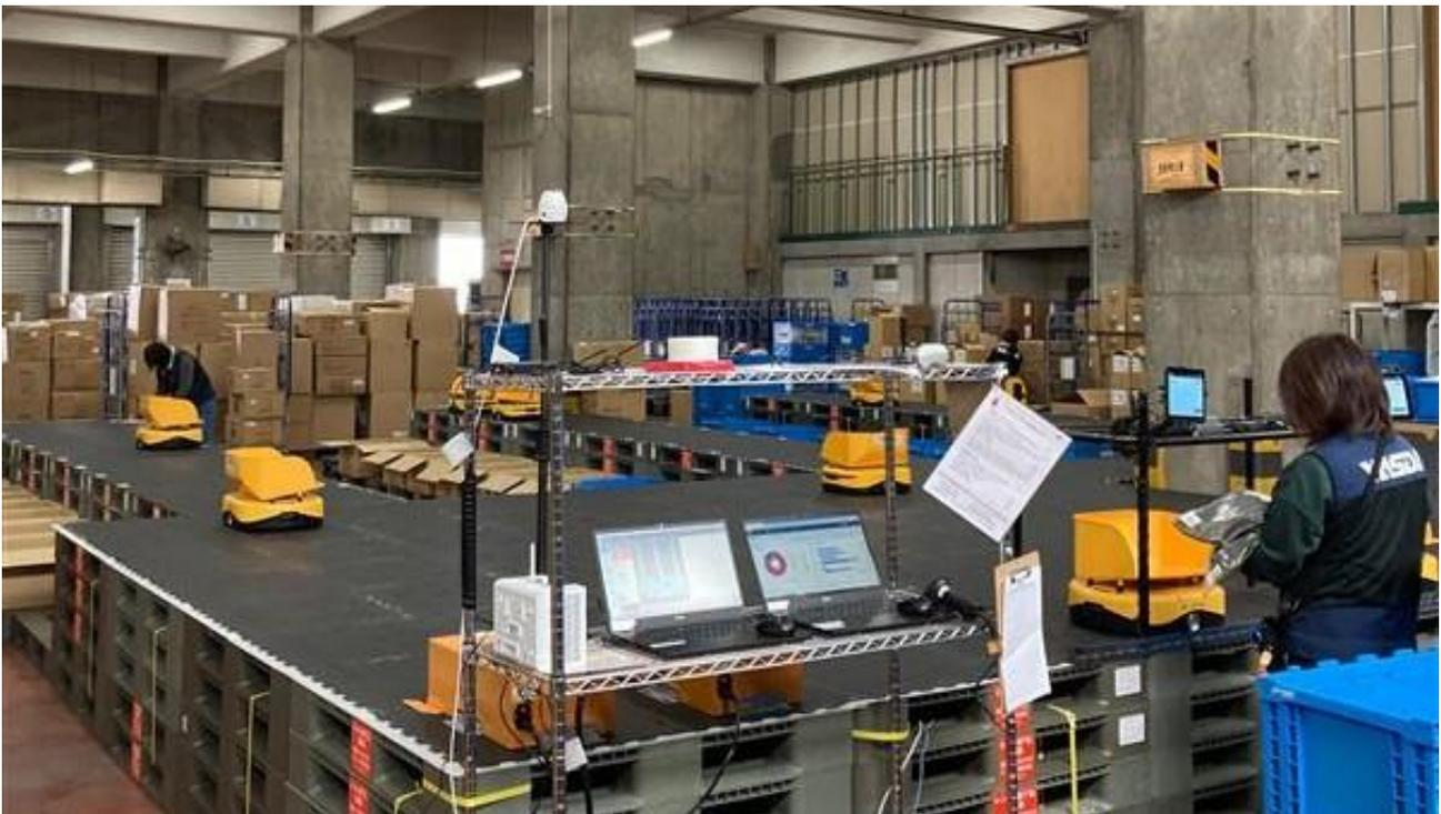
北海安田倉庫では、作業者の手作業によるシングルオーダーピッキングで1日 3,000 ピースを作業上限としていましたが、t-Sort で仕分けることで1日最大 7,000 ピースの作業上限へと作業能力を向上させています。
