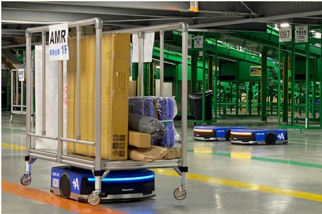
X フロントア佐川急便中継センターでは、ベルトコンベア等で構成される自動仕分け機でその9割を処理しますが、自動仕分け機に乗らない大型で搬送することができない不定形の荷物は従来通り人の手で仕分けられ、台車で搬送されていました。過去にロボットの導入による自動化を試みましたが、24時間絶え間なく荷物と人が行き交う環境下で、臨機応変に搬送工程を効率化できるロボットがなく課題を抱えたままでした。
