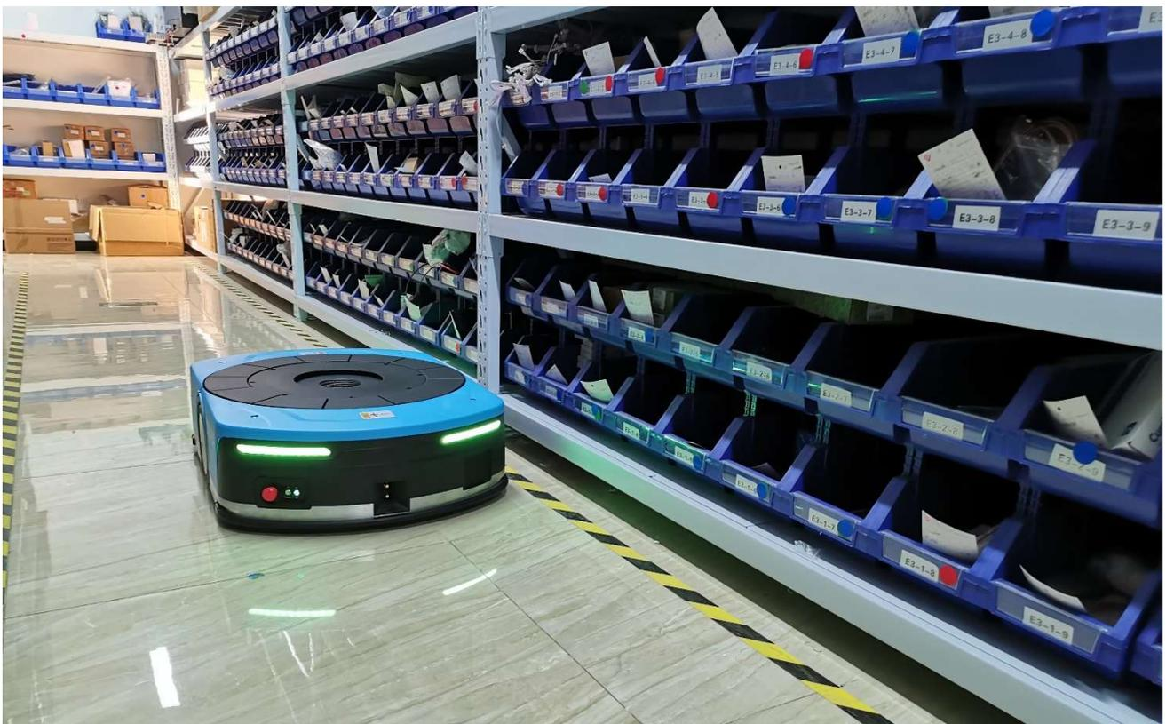
写真は AMB-800K（800kg 可搬の SLAM 式 AMR）。ジャッキアップテーブルに回転機構を加えたことで、より安全に無駄のない搬送を実現。かご車、ピッキングカート、パレタイズ商品等を無人で積み込み・搬送・積降することが可能。
