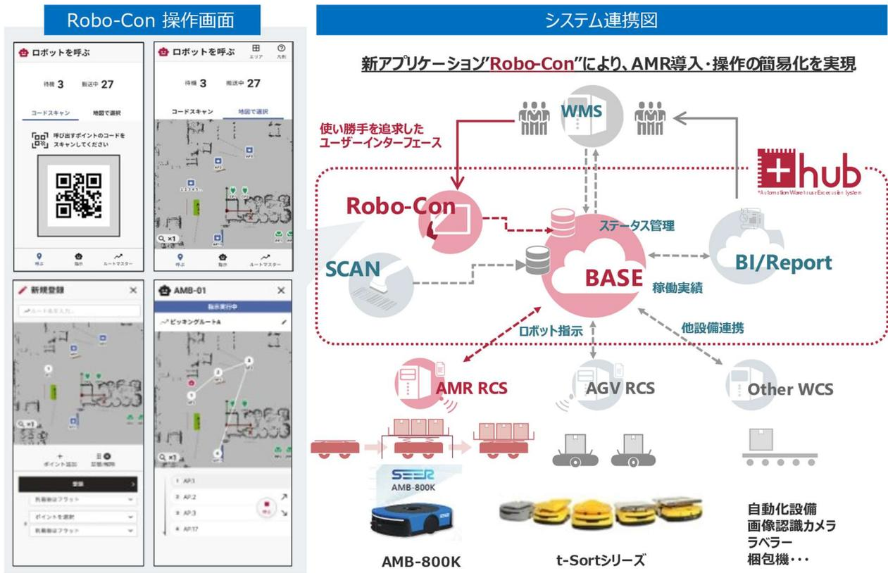
「+Hub」とSEER社のRCS（ロボットコントロールシステム）との連携により、ロボットの呼出、ルートやロケーション設定、無人での積み込み・搬送・積降ろし指示がタブレット端末から直感的に可能となり、これまで大きなコストと時間が課題であったAMR導入を手軽に簡単に実現。2022年4月からのAMB-800KのRaaS本格展開に向け、現在実証実験の最終フェーズ段階。
