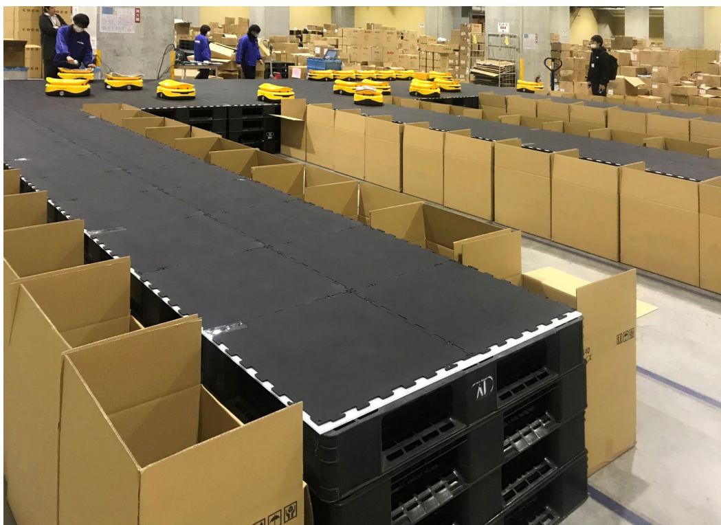
プラスチックパレットをソーティングロボットの走行ステージとした例。高い柔軟性と機動力を併せ持つ次世代型ソーターシステム。
