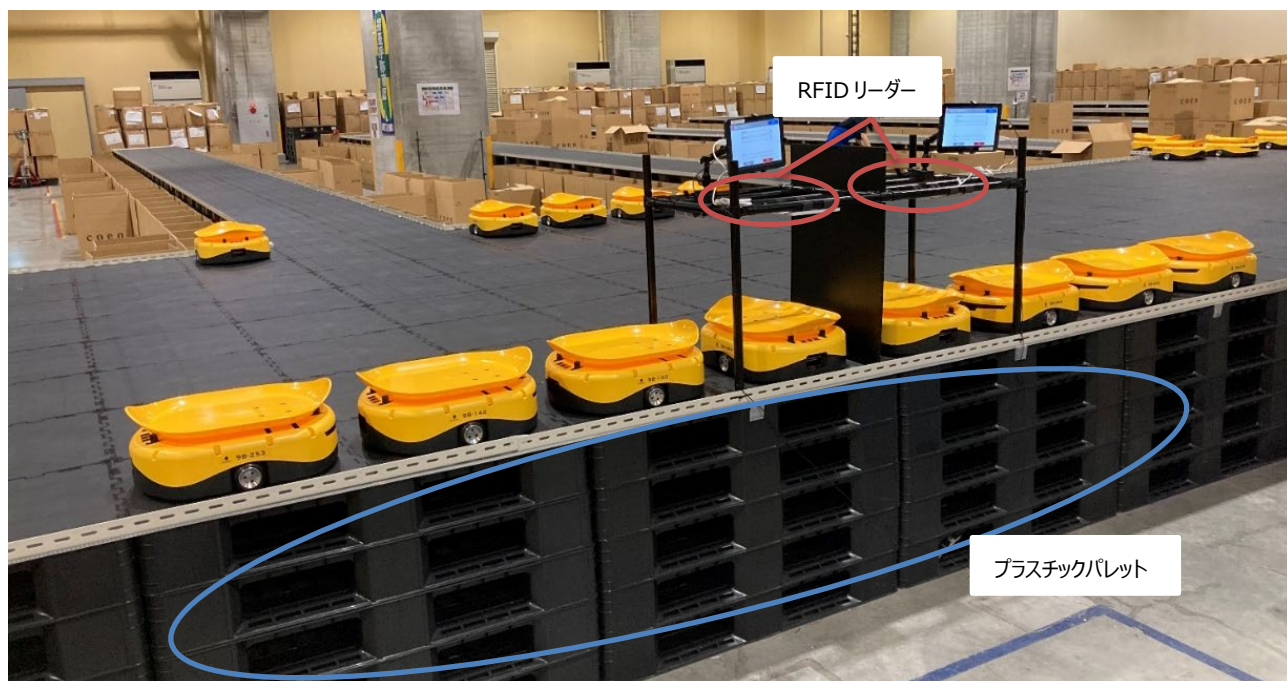
物流現場で一般的に使用されるプラスチックパレットをロボット走行ステージに活用。投入時の商品読み取り機は RFID リーダーを採用。
