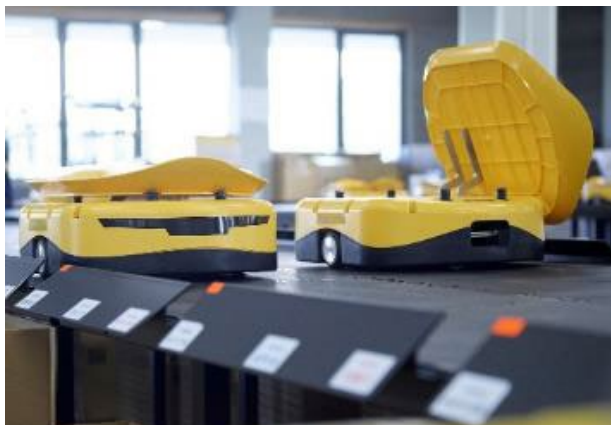
<t-Sort : 5kgまで軽量物の仕分け作業向け>
