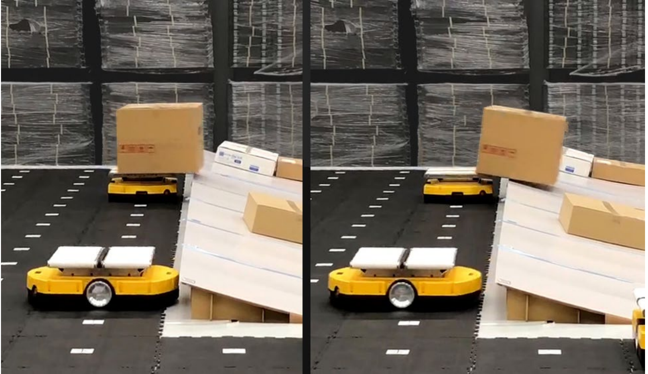
<t-Sort+とスローブを接続する事で、箱物・非定型物・重量物等の仕分けの省人化が可能>
