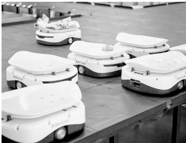
ソーティングロボットシステムは荷物の取扱量に応じたシステムを構築できる
